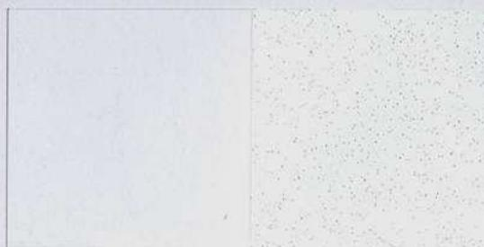
Smalto per pavimenti; a destra con aggiunta di Additivo Antisdrucchiole.
