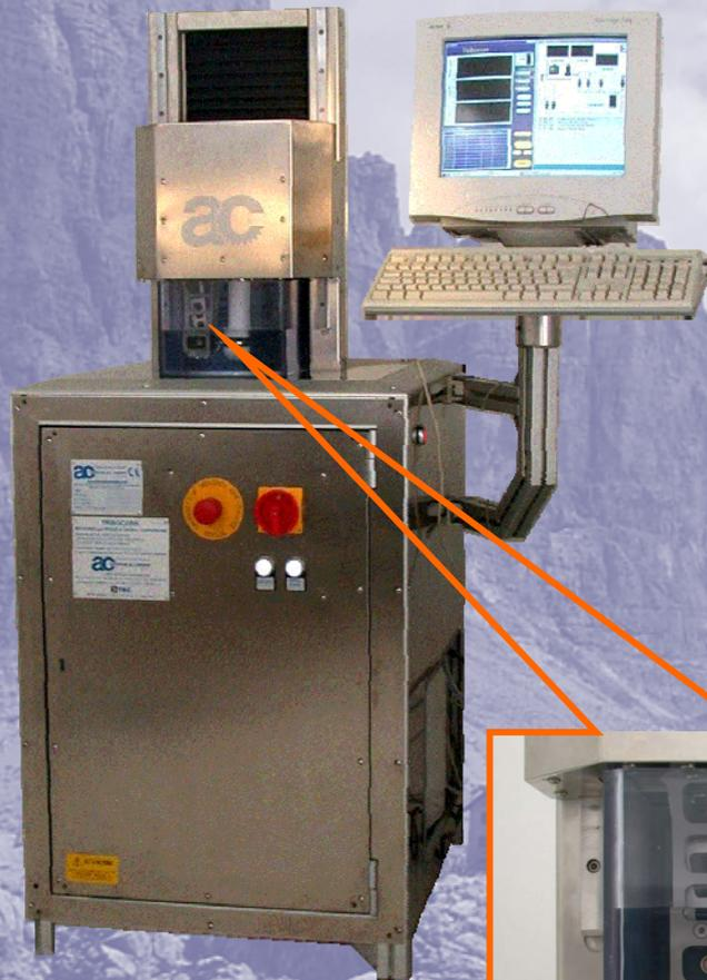
**Sistema completamente automatico per test di usura corrosione**
