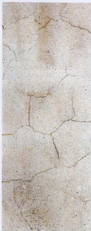
Nella foto: la formazione di cavillature di un prodotto tradizionale a base di legante sintetico.
